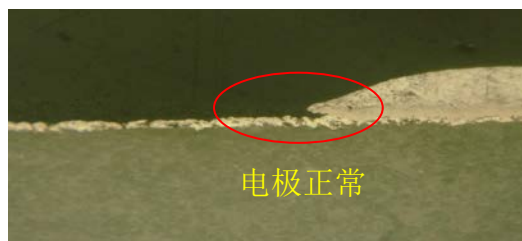
2 右端正电极正常情形
