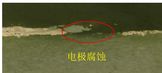
图 1 左端正电极被腐蚀现象图
